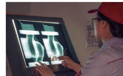
通过辐射渗透检测对阀门铸件部分的铸造缺陷进行无损检测。
