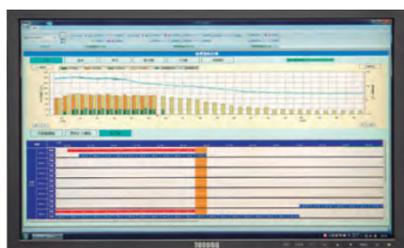
实用优化软件包根据气象预测数据，通过运算决定在什么时间启动/停止哪个热源设备，并用图表显示温度变化的预测值和实测值、制造热量的计划和实测值。
