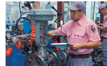
进行工业阀门的装配，并进行发货前的检测。
