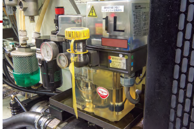
组装到机床中，对轴、轴承部分进行喷雾式润滑的喷雾润滑装置。
