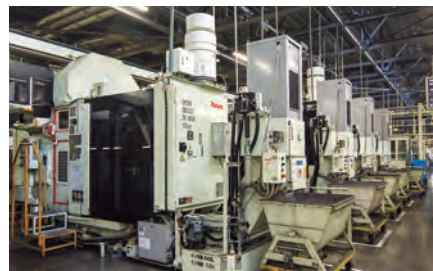
安装于大泉工厂 第5工厂内的生产现场的加工中心。加工发动机的气缸盖。
