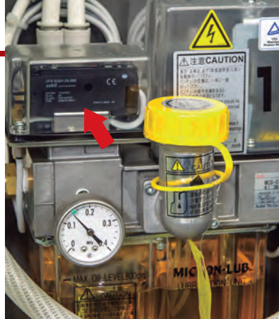
阿自倍尔株式会社的光电传感器，用于对喷雾润滑装置向文丘里管滴油的情况进行监视。
