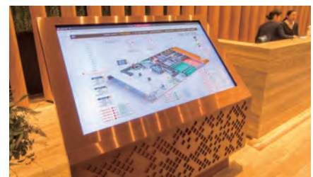
Gayson Tower的办公楼层前台旁边安装的数字标牌。平时显示资讯画面，当有人来参观Gayson Tower的楼宇管理情况时，可切换为savic-net G5的监控画面。
