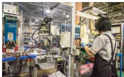
用于对差压/压力变送器的传感器部分的基板进行自动焊接的装置。通过AI图像处理进行合格与否的判定。
