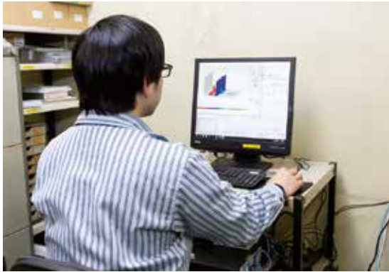
在现场附近监视设备运行状况的 LCR (Local Control Room) 上安装的调节阀维护支持系统的监视终端。可通过易于理解的图表确认调节阀维护支持系统收集的阀门运行数据。
