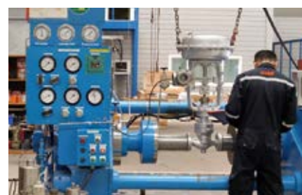
阀门进行开放检查、维修后，根据尺寸实施耐压、气密性试验，确保万无一失。
