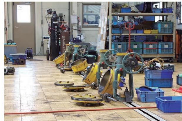
将从顾客装置上取下的阀门按各部分拆开，根据内部的清洁及磨损/老化程度实施维护及零部件的更换、涂装。阀门焕然一新后，将重新安装到顾客的装置上。
