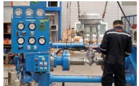
阀门进行开放检查、维修后，根据尺寸实施耐压、气密性试验，确保万无一失。
