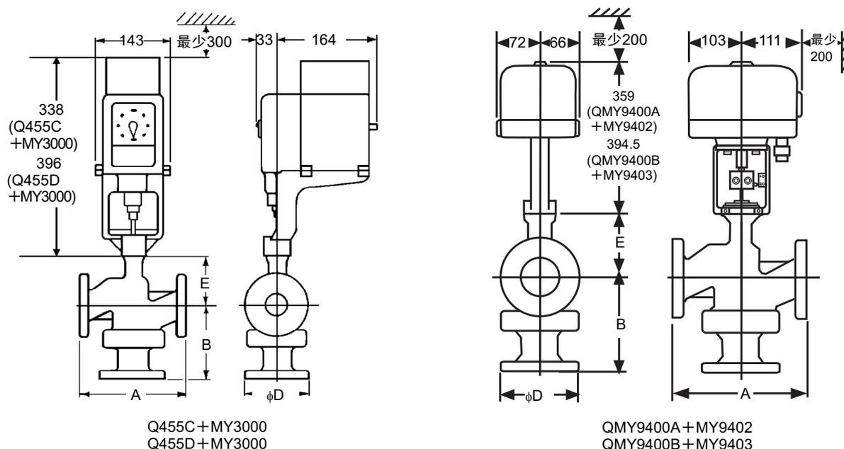
图 2 与各种执行器的安装尺寸(mm)
