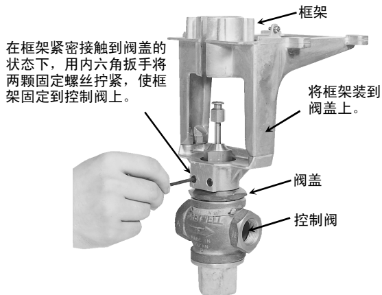
图2 将框架安装到阀盖上
