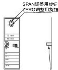
图4 POT/I转换器的前面图
