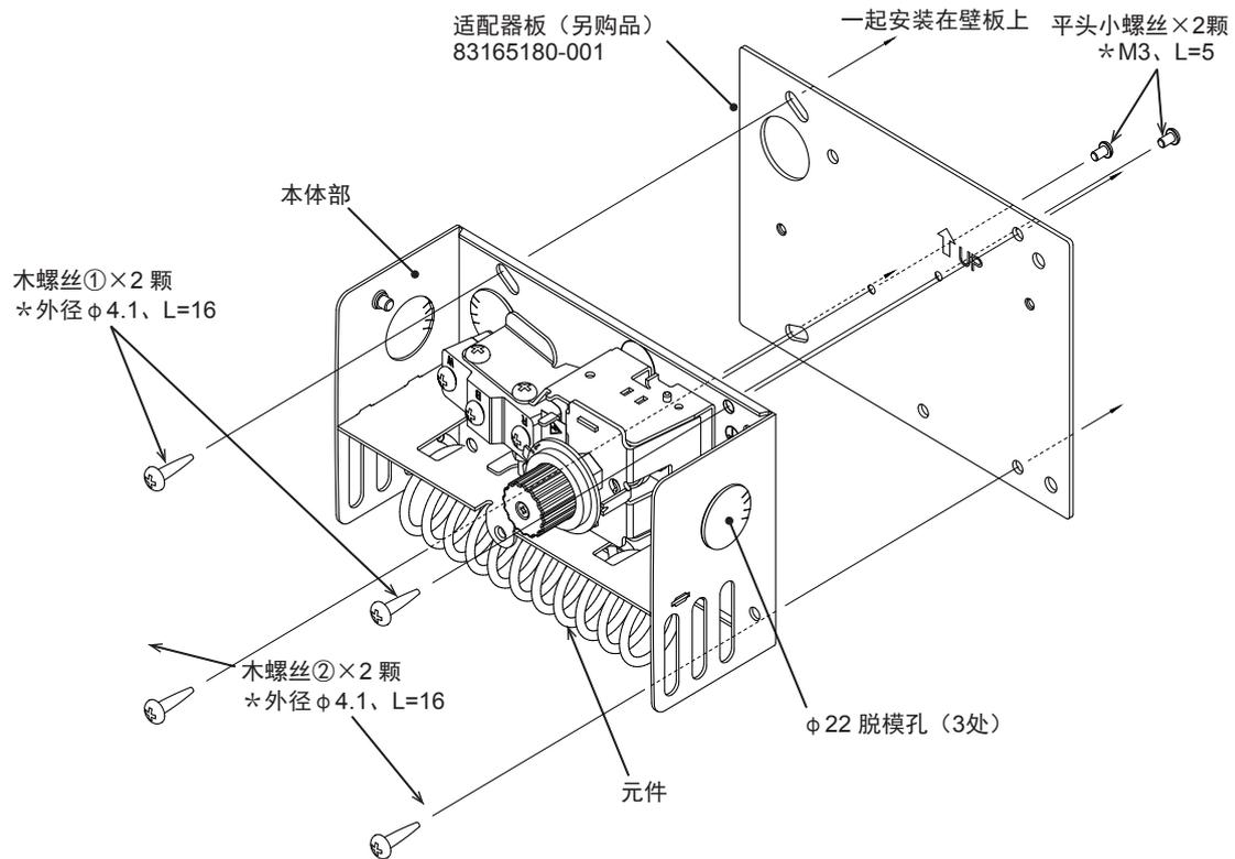
(注) 『图11 安装说明图』是示例, 表示型号T631A1121-1。
