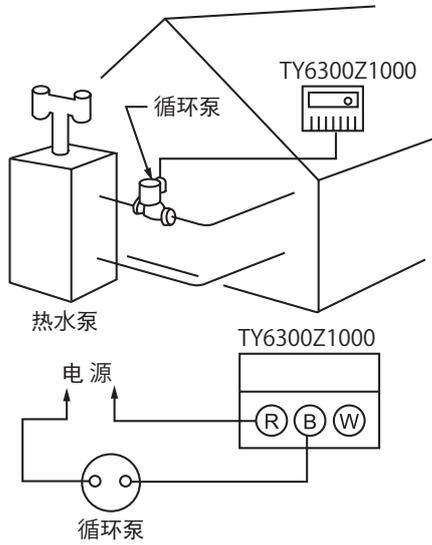
图15 热水锅炉(循环泵)的控制器
