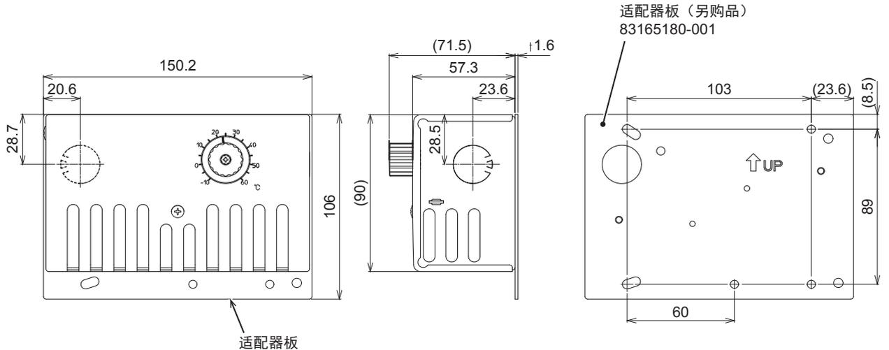
图9 安装尺寸图 (旧型产品T631A1121-1的替换) (mm)
