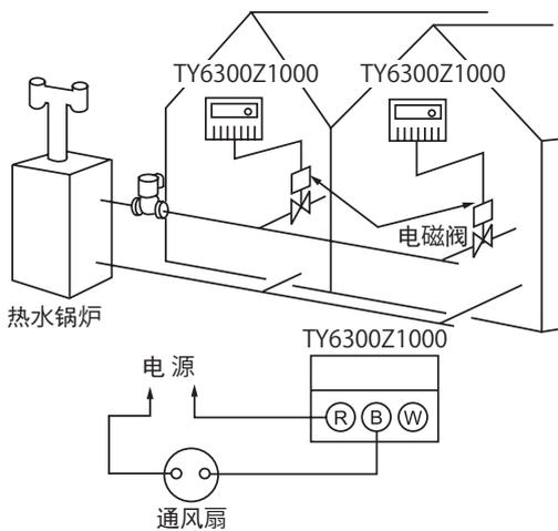
图16 热水锅炉(电磁阀)的控制器
