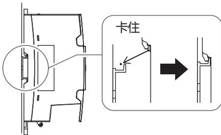
(3) 将2个主体下侧的DIN固定器上推到位。
