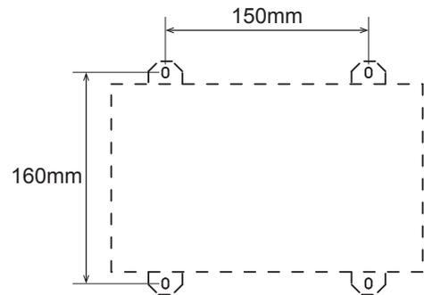
(2) 上推主体上侧的2处DIN固定器, 下拉主体下侧的2处DIN固定器。
