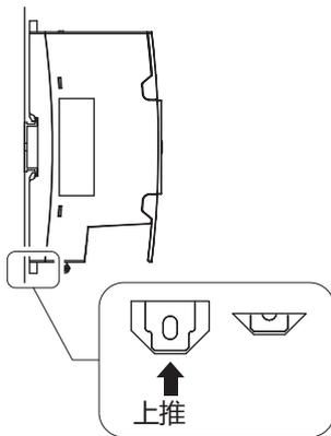
(4) 确认将主体上侧、下侧的DIN固定器 (4个) 固定在DIN导轨上。
