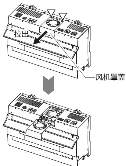
(3) 拔出风机组件的连接器。
