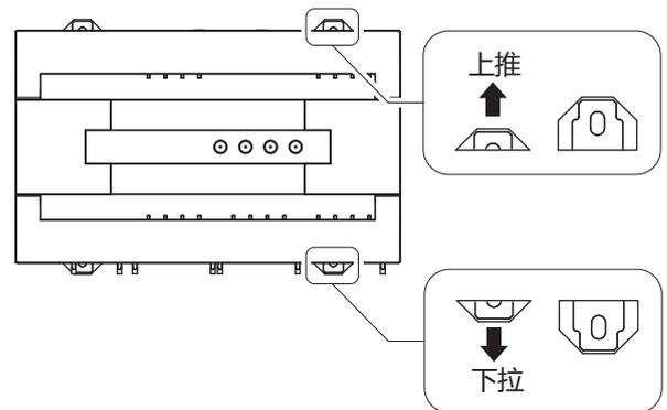
(3) 用4处DIN固定器的孔, 使用M4螺丝固定主体。
