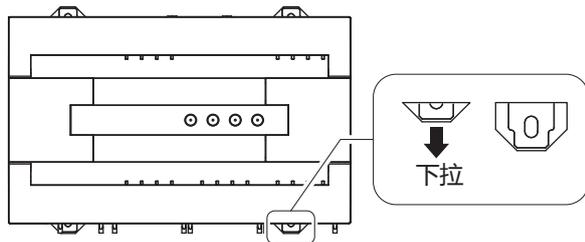
(2) 把主体上方的DIN固定器卡在DIN导轨上并确认已卡住。
