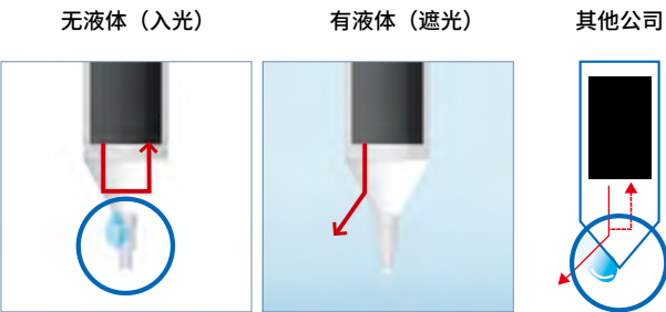
利用液体有无时的折射率的差异进行检测。
