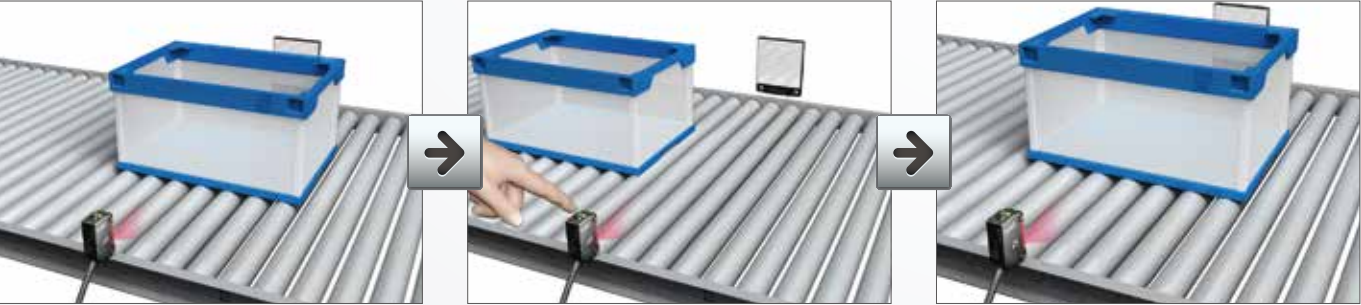
因为检测物体是半透明体, 所以光会穿透过去。 在无检测物体的状态下进行无工件调谐。 可以检测半透明物体 ※ 检测透射率高的物体时, 请使用透明物体检测用 HP7-C。并通过实际的检测物体进行动作确认。
