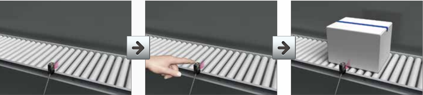
工厂出厂时(最大灵敏度) 检测出背景物体。 进行无工件调谐 不会检测背景物体。 可稳定检测出从传感器经过的纸箱。
