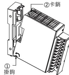
拆卸時，按壓上部卡銷的同時往面前輕拉本體。
