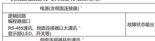
\*：电源、侧面连接器环形通讯、RS-485通讯、侧面连接器以太通讯在保持绝缘关系的状态下与侧面连接器连接。
