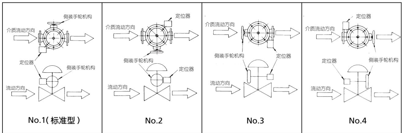
图7 配管安装示意图
