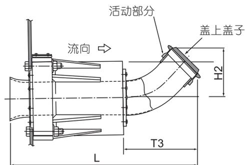
图 7. 检测器 (弯管法兰型)
