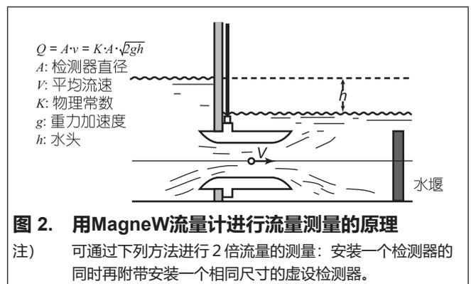
图 2. 用MagneW流量计进行流量测量的原理
