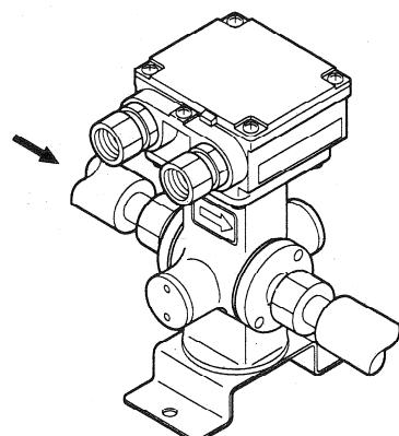
图 2-34 安装例 (管接头型)
