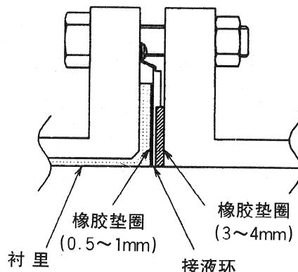
图 2-31 在 2.5A-200A 的条件下接液环为 SUS 以外的材质的场合（使用橡胶垫圈）
