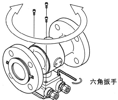
图 2-4 改变端子箱或转换器的方向
