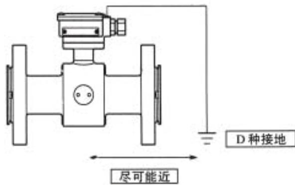
图 2-33 由外部接地端子接地
