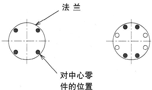
图 2-10 垂直安装的场合（下侧的法兰上安装 4 个）
