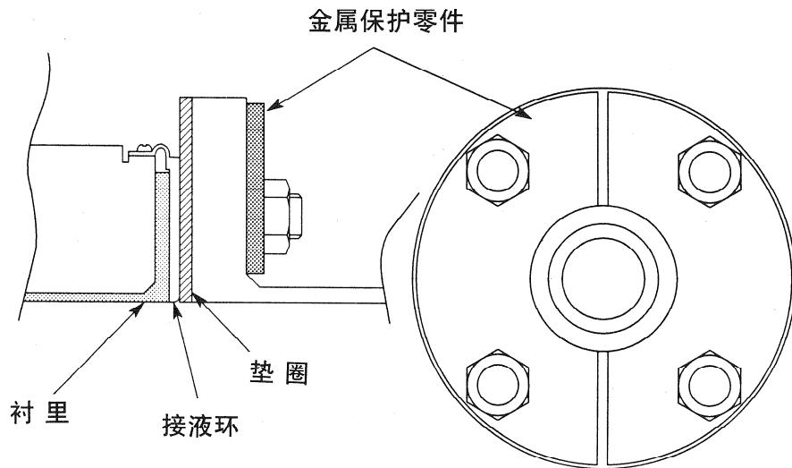
图 2-15 接液环是 SUS 材质的场合 (使用金属保护零件)
