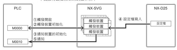
① 本機在設定「觸發掃描」的時間點讀取設定表各行的設定備份觸發裝置, 監控從 OFF 變成 ON 的裝置。當觸發裝置從 OFF 變成 ON,則啟動設定 備份。觸發掃描與觸發檢測的時間點與觸發資料傳輸相同。
