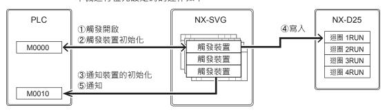
① 本機在設定「觸發掃描」的時間點讀取設定表各行的開啟寫入觸發裝置與關閉寫入裝置,監控從 OFF 變成 ON 的裝置。當觸發裝置從 OFF 變成 ON,則啟動位元設定。觸發掃描與觸發檢測的時間點與觸發資料傳輸相同。
