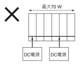
若這樣進行電源佈線,在不是 能夠進行並聯運轉的DC 電源的 情況下,可能會縮短DC 電源的 故障及壽命。請仔細確認、設計 所使用的DC電源的規格。
