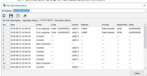
「履歷 No.1」中·在對分配於 LAN2-5 之 NX 的位址 14594 ( 迴圈 1 手動 MV ) 執行 0x000002BC ( 700 ) 的資料寫入時·從 NX 接收到錯誤代碼 0x00000023 的回應·由此判斷發生錯誤。
