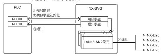
① 本機在設定「觸發掃描」的時間點讀取設定表的 IP 編址觸發裝置、監控從 OFF 變成 ON 的裝置。當觸發裝置從 OFF 變成 ON,則啟動 IP 編址。觸發掃描與觸發檢測的時間點與觸發資料傳輸相同。
