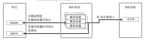
① 本機在設定「觸發掃描」的時間點讀取設定表各行的設定還原觸發裝置, 監控從 OFF 變成 ON 的裝置。當觸發裝置從 OFF 變成 ON,則啟動設定 還原。觸發掃描與觸發檢測的時間點與觸發資料傳輸相同。
