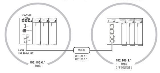
如以下範例所示·如果在 LAN1 設定 192.168.0.1 的路由作為預設閘道的網路,則可在 LAN1 側的工作表可設定 192.168.1.\* 等不同網路的機器。
