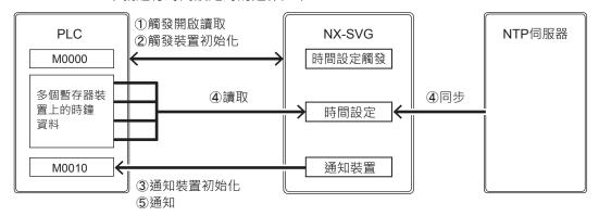
① 本機在設定「觸發掃描」的時間點讀取時間設定觸發裝置,監控從 OFF 變成 ON 的裝置。當時間設定觸發裝置從 OFF 變成 ON,則啟動時間設定。觸發掃描與觸發檢測的時間點與觸發資料傳輸相同。 起動時執行設定為「有」的情況下,在本機啟動時啟動時間設定。
