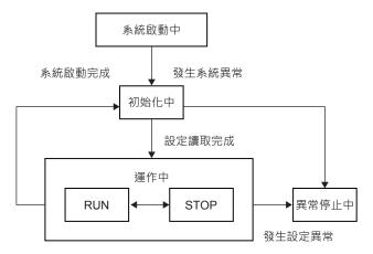
系統啟動中 : 電源輸入後系統啟動中的狀態 初始化中 : 系統啟動後設定讀取中的狀態
