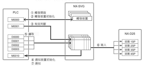
① 本機在「觸發掃描」設定的時間點讀取設定表的觸發裝置,監視是否變成觸發開啟(OFF  $\rightarrow$  ON 或 ON  $\rightarrow$  OFF)。若變成觸發開啟則啟動觸發資料傳輸
