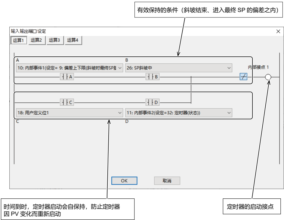
DI分配（内部接点2）：输入输出端口设定
