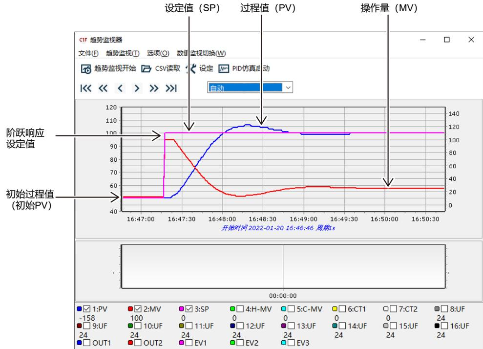
在准备收集这些数据时，请事先确定满足以下条件的初始过程值 (稳定状态下的 PV) 和阶跃响应设定值。
