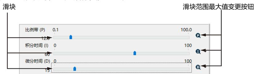
滑块的范围可用[F][I][D](变更滑块范围最大值)按钮进行变更。每次单击此按钮，滑块的最大值都会逐步增大，超过上限时会恢复到最小的设定范围。点击按钮右侧的[▼]按钮时，显示如下图所示的菜单，可以直接设定范围。
