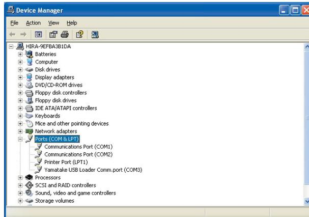
⑥ 启动SLP、选择[Menu] → [Option]，设定先前确认过的通信端口后点击[OK]按钮，完成变更。
