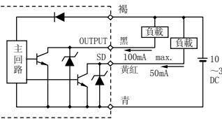
(注) 圖中的顏色為電線絕緣外皮的顏色。
