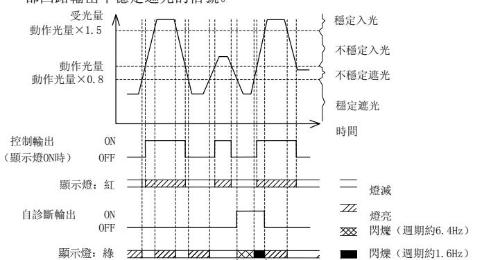
A: 穩定遮光→不穩定入光→穩定遮光和受光量變化的場合，穩定顯示燈閃爍，可以輸出。
