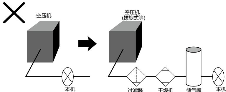
如上图所示，设置除去油分、水分、铁粉等垃圾的装置，作为偏流对策，请在2次侧设置储气罐等。
