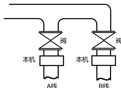
对策2. 在设计上，未使用线的本机输出(4~20mA、脉冲)不引入到输入侧机器中
