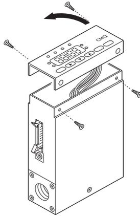
④把设定显示部放回到本体上,固定由②步骤取出的平头螺丝。
