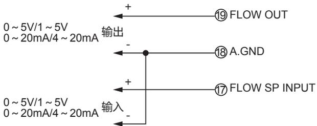
• 使用电位计时的模拟输入(0 ~ 5V)
