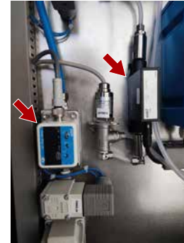
20mL/分という微小な過酸化水素水を流す熱式微小液体流量計(形 F7M)(右)と、過酸化水素水と空気を均一に混合して噴霧する際に用いられるエア管理用メータ(左)。
