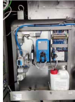
アイソレータ内に装備されているアズビルテルスターのionHP+。アイソレータでのプロセス終了後、過酸化水素水を用いてハウジング内の滅菌作業を実施する。
