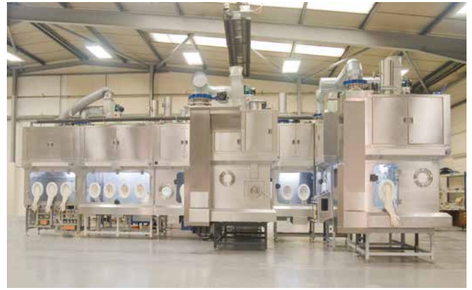
アズビルテルスターが提供するアイソレータ。隔離されたユニットの中で有害・有毒なプロセス処理を行うことで作業者の安全を守るための装置。
