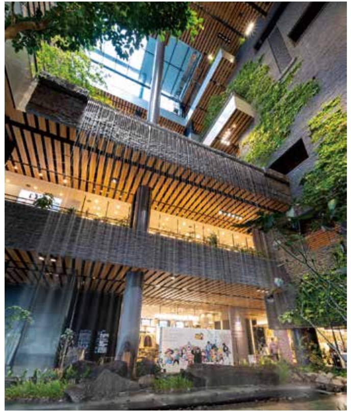
ビルエントランスの脇にある屋内立体庭園「ぼうけんの社」。1～7階までの吹抜け空間に滝が流れているという、空調制御上難易度の高いスペースで、庭園周辺の温度、湿度が快適に保たれるように現在も調整を続けている。
