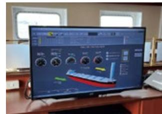
船内の食堂・歓談スペースであるOfficer's Messroomに設置された大型モニター。Harmonas-DEOで制御している硬翼帆の状態が表示され、同室を訪れるゲストなども操舵室と同様に硬翼帆の状態を確認することができる。
