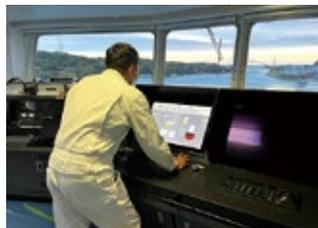
操舵室に設置されたIAS(Harmonas-DEO)。風の状態から自動制御された硬翼帆の状態をリアルタイムに確認できる。緊急時などはオペレータからの操作も可能となっている。
