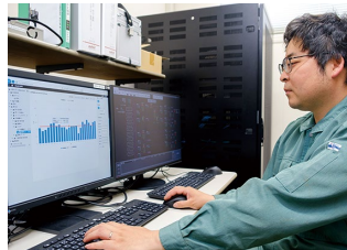
サーバ室に設置されたEMSのEneSCOPE(手前)とDCSのHarmonas-DEO(奥)のモニター画面。
