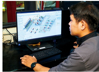
BEMSとして新たに導入されたsavic-net G5の監視画面。設備の稼働状況を分かりやすいグラフィックで確認することができる。
