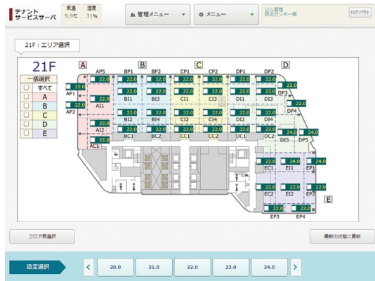
フロアの空調ゾーンと温度計測値を表示したテナント向けサービスの画面。
