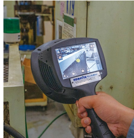
エア漏れ発生箇所がFLIR Si124に搭載されたモニタ画面上に分かりやすく表示される。
