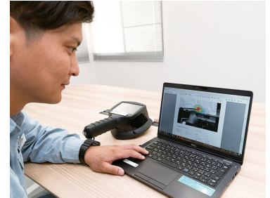
FLIR Si124から提供されるレポート機能により、全工場のエア漏れ点検の結果を、Web画面上でスムーズに共有可能。エア漏れしている箇所や量が色で表示される。
