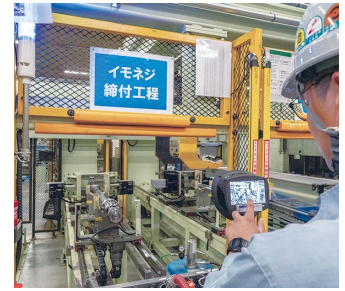
工場内の高所の配管や人が入りにくい設備の中も、離れた場所からFLIR Si124でエア漏れを検知できる。
