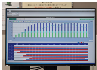
U-OPTのモニター画面。冷凍機の最適化運転ガイダンスを24時間先まで30分単位で提示する
