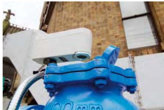
Re-Picの設置例。小型で外部電源不要のため、誰にでも簡単に設置できる（昼夜撮影可）
