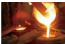
6 フキ（溶解作業）：こしき（溶解炉）で約1,400〜1,500度まで温度を上げて溶かした鉄を、鑄型に流し込む。鉄の溶け具合は職人の経験による判断。鉄瓶作りのハイライトだ。
