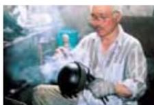
8 着色と仕上げ：ヤスリや砥石等で注ぎ口や鑄ばりを手入れした後、約300度くらいに熱した漆を手塗りする。最後につるを取り付け完成。
