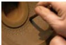
2 紋様押し：鑄型が完全に乾く前に、紋様をへらやアラレ押し棒を使って押ししていく。紋様押しの道具も、職人自ら製作。アラレの深さや形によって、鉄瓶はさまざまに表情を変える。
