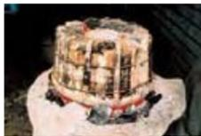
3 型焼き：紋様押しが終わった鑄型を完全に乾かし、炭火で焼き固める。鑄型を繰り返し使用できるのは、多くても3〜4回。一度きりのものもある。
