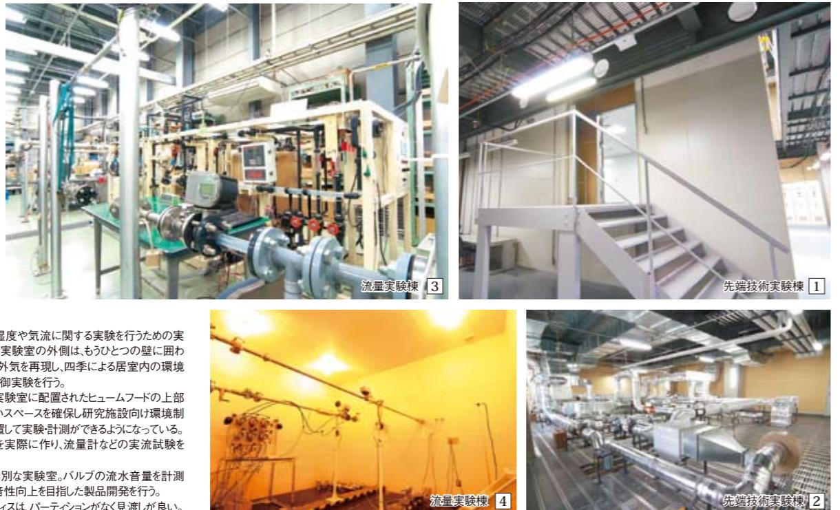
① オフィス内の温湿度や気流に関する実験を行うための実験室。外側はもうひとつ壁に囲われ、春夏秋冬の外気を再現し、四季による居室内の環境変化に対する制御実験を行う。
