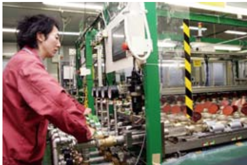
新基準に対応するために新たに導入した自動検定装置 ピストンブルーバー。検定時間の大幅な短縮を実現。
