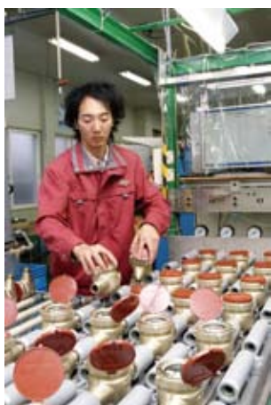
新基準に対応するために新たに導入した自動検定装置 ピストンブルーバー。検定時間の大幅な短縮を実現。
