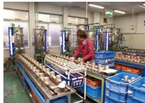
従来の水道メーター検定装置（基準タンクを使用）。
