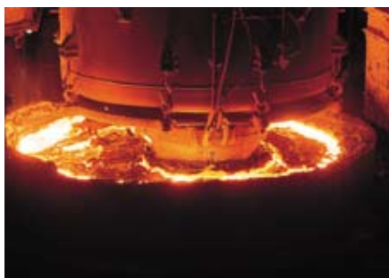
RH真空脱ガス設備。 (新日本製鐵株式会社 名古屋製鐵所 提供)
