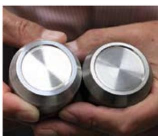
ダイヤの入ったジェルを金属と金属の間に入れて磨く鏡面仕上げ。左が鏡面仕上げの作業を行ったもの。
