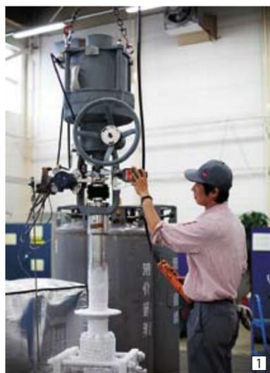
1 LNGや液化窒素が自動調節弁内を通ると、バルブの表面は霜がついた状態になる。この状態でも確実に制御をすることが要求される。
