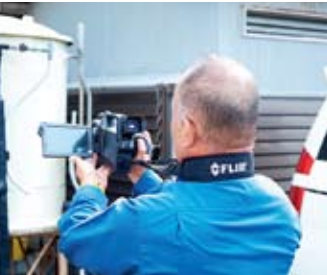
集中監視システムと併せて導入した赤外線サーモグラフィFLIRを活用し、温泉貯湯タンクの断熱性能の劣化診断など、新サービス展開も検討されている。
