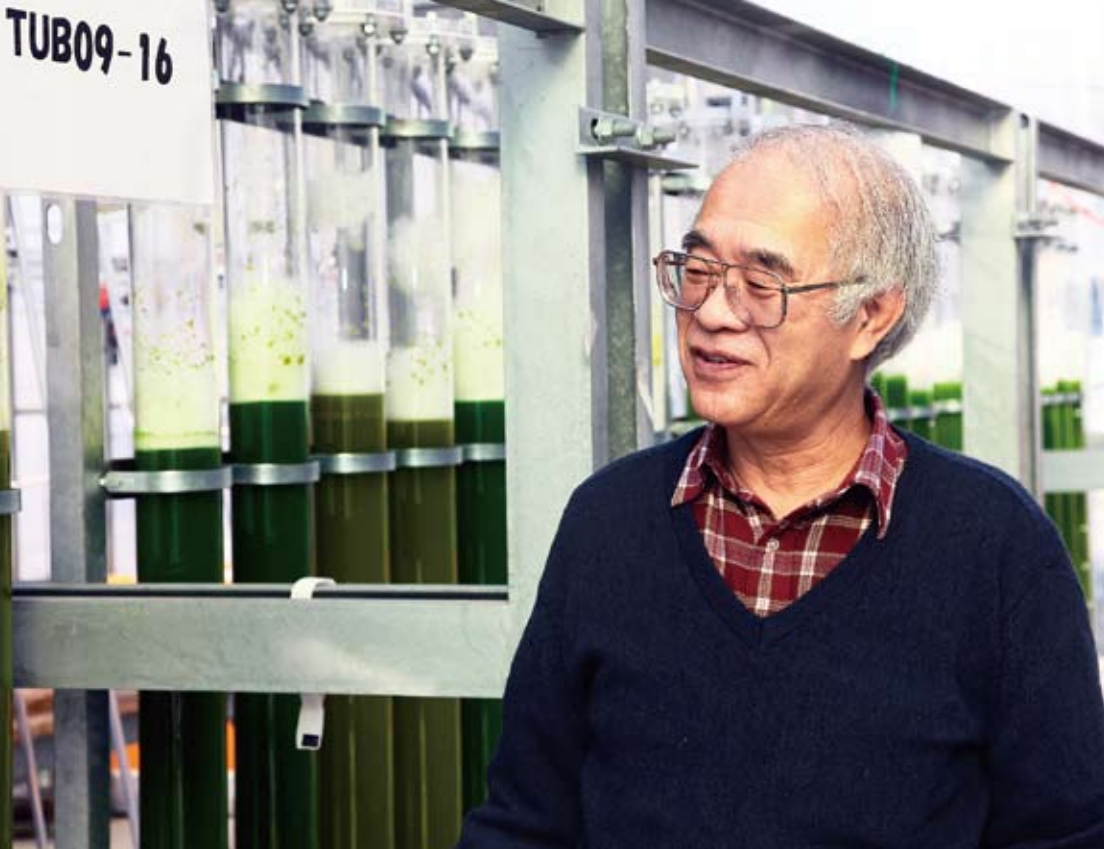
ボトリオコッカス・ブラウニーの培養容器について説明する渡邊教授。縦置きだとCO 2 は下から供給でき、効率的とのこと。これが横置きになると、日光を受けるのにはよいが、CO 2 の供給に苦勞するそうだ。
