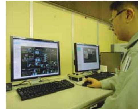
本庁と県内に点在する水道事務所や浄水場に設置された監視操作端末。リアルタイムで送水管理情報の監視、閲覧、映像監視を行い、状況に応じて操作も行える。同時に水道料金の検針業務も実施。
