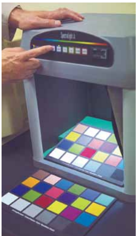
中嶋研究室には至る所に光や色に関連する装置が置かれている。これは真昼の直射日光や夕方の光、各種照明などで色の見え方がどのように変化するかを確認できるマシン。初歩的な授業やオープンキャンパスなどで光と色の不思議さを紹介するという。
