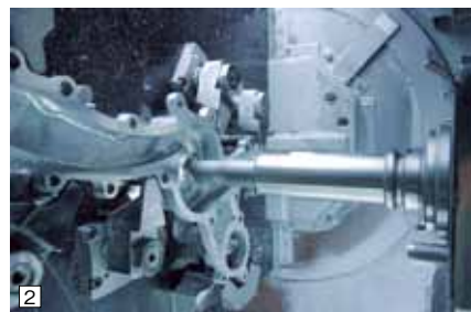
② マシニングセンタ内でのセミドライ加工の様子。
