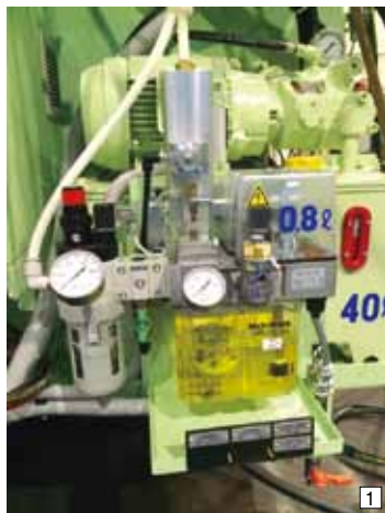
① マシニングセンタに実装されているセミドライCPL霧化装置。
