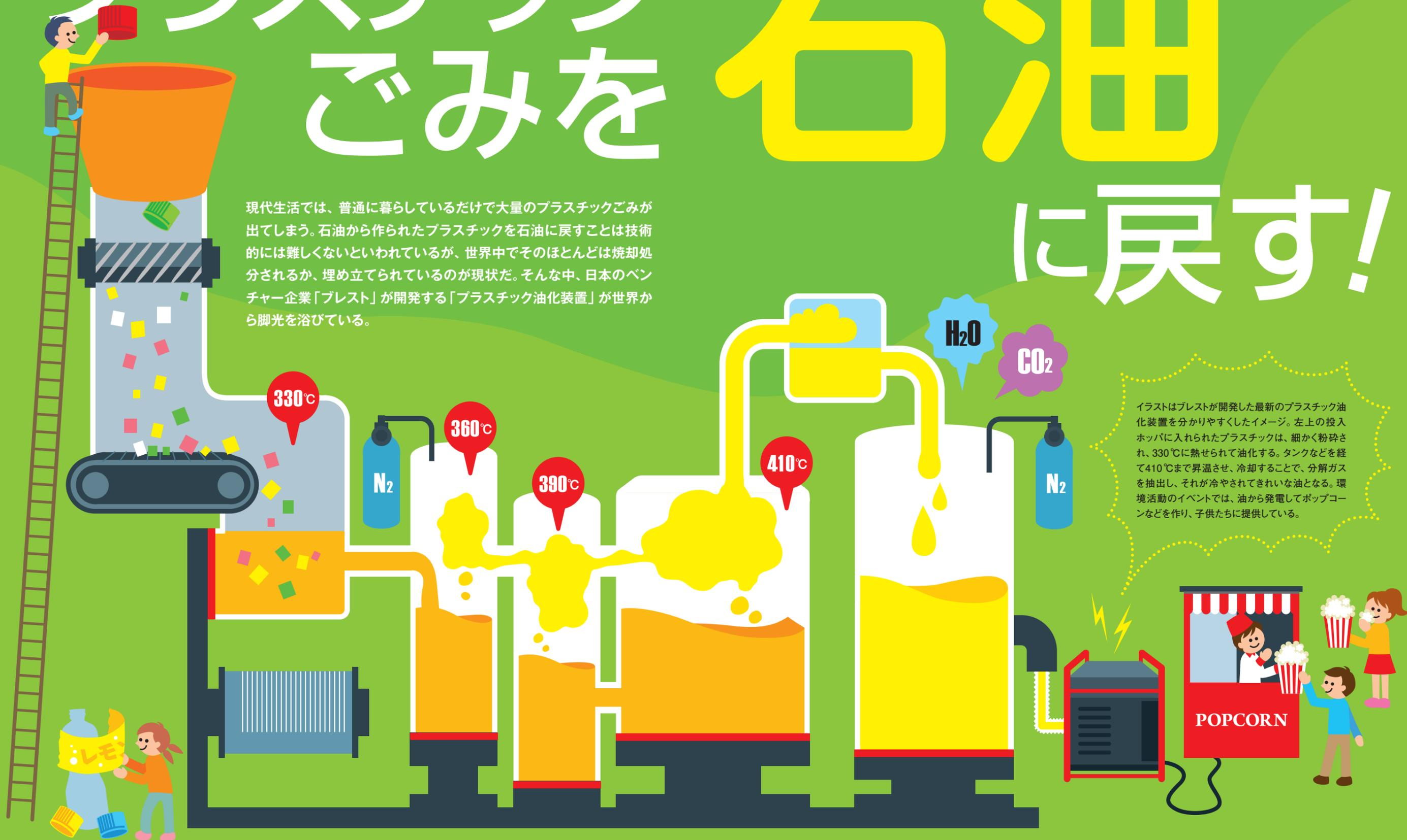
イラストはプレストが開発した最新のプラスチック油化装置を分かりやすくしたイメージ。左上の投入ホッパに入れられたプラスチックは、細かく粉碎され、330℃に熱せられて油化する。タンクなどを経て410℃まで昇温させ、冷却することで、分解ガスを抽出し、それが冷やされてきれいな油となる。環境活動のイベントでは、油から発電してポップコーンを作り、子供たちに提供している。
