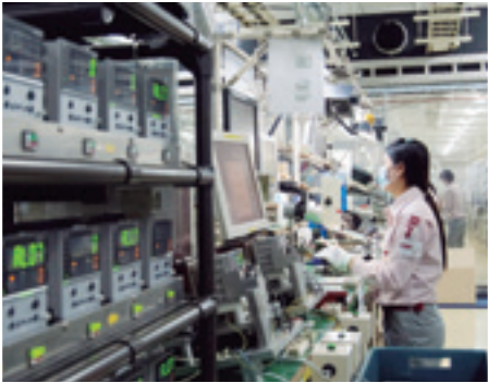
組立てが完了した温度調節計の検査を行う。
