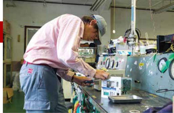
保全作業の様子。ウレタンの製造現場のガス検知器を引き取り点検・修理しているところ。
