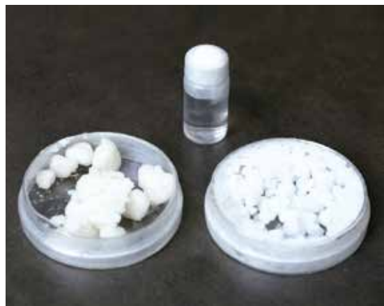
シャーレに入っているのは木材パルプ。これをTEMPO触媒酸化すると繊維がナノ分解され、中央奥の透明なゲル状になる。
