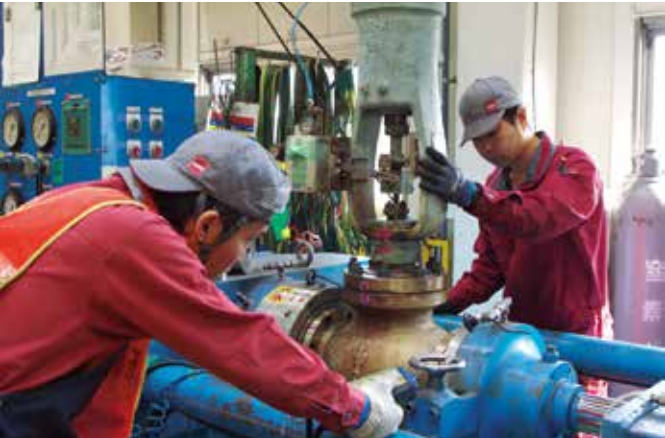
整備が完成したバルブは、専用試験機を用いて各種の機能検査を行う（耐圧、気密試験・漏洩試験・作動試験等）。
