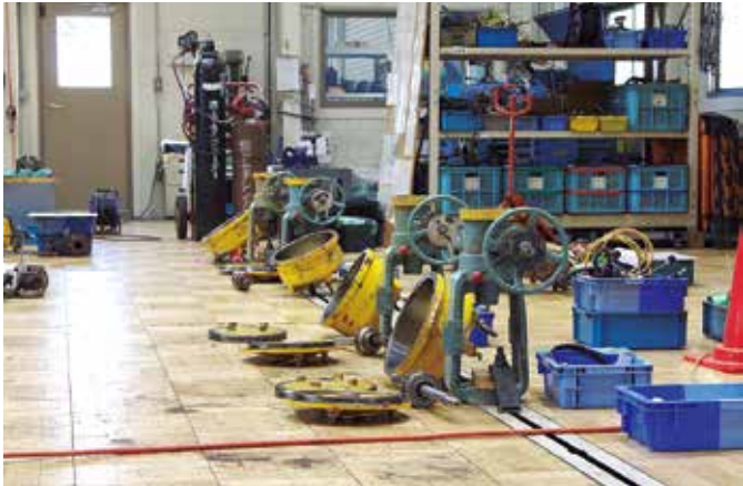
お客さまのプラントから預かったバルブをパーツごとに分解し、内部の清掃や摩耗・劣化具合に応じて修繕や部品の交換、塗装を施す。バルブは新品同様の状態になり、再びお客さまのプラントへ戻される。
