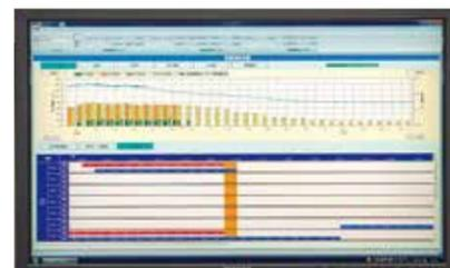
U-OPTは、気象予測データを基にどの熱源機器をどのタイミングで起動・停止させるかを演算により決定する。また温度変化の予測値と実測値、製造熱量の計画と実測値をグラフで表示している。
