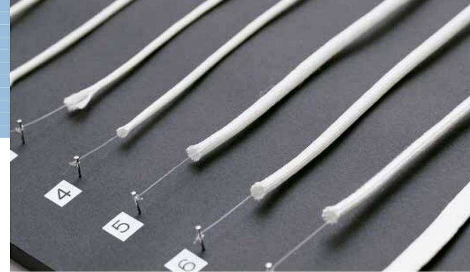
シルク人工血管のサンプル。直径1~6mmのものを作製しており、極めて繊細な作りだ。
