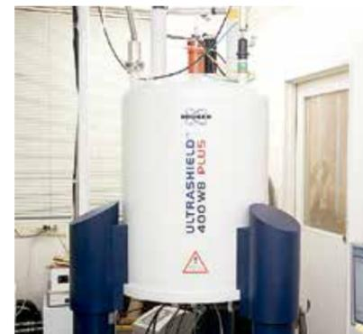
NMR装置。下部に溶液や固体をセットし、強い磁場を発生させることで物質を解析する。
