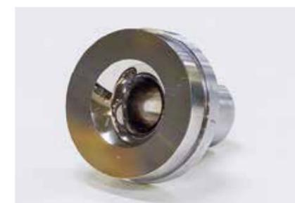
臨界（音速）ノズル。国家計量標準から直接校正を受けた特定二次標準器を使用している。
