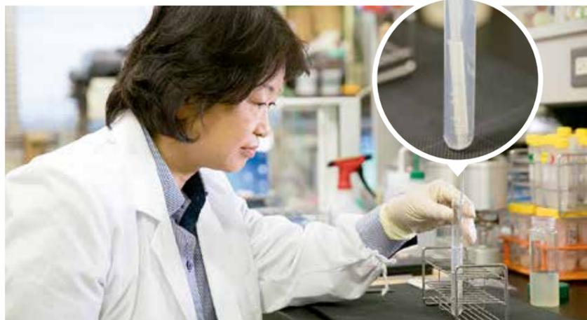
繊維会社から届いたシルク的人工血管に、血液漏れを防ぎ、強度を高めるためにさらにシルクの水溶液でコーティングを施す非常勤研究員の鈴木育絵さん。シルクの水溶液に漬けたシルク人工血管は、繊維間に残存した空気のためコーティング漏れができないように専用機器で脱気する。
