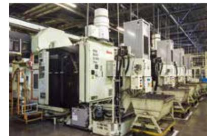
大泉工場 第5工場内の生産現場に設置されているマシニングセンター。エンジンのヘッドシリンダーを加工している。
