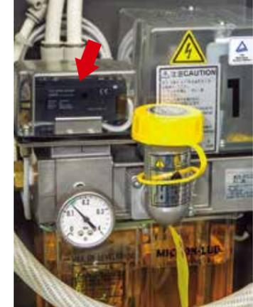
マイクロループ潤滑装置 ベンチュリ部への油の滴下を監視するアズビル株式会社の光電センサ。そのほかにも油量不足検出など、マイクロループ異常として警報を上げることができる。
