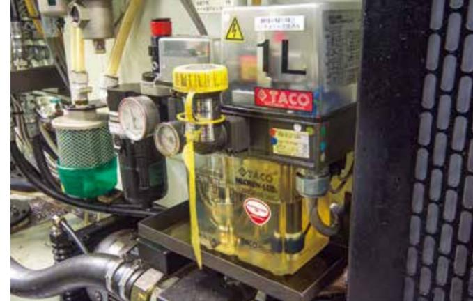
工作機械に組み込まれ、軸・軸受け部分に対して噴霧式の潤滑を行うマイクロループ潤滑装置。
