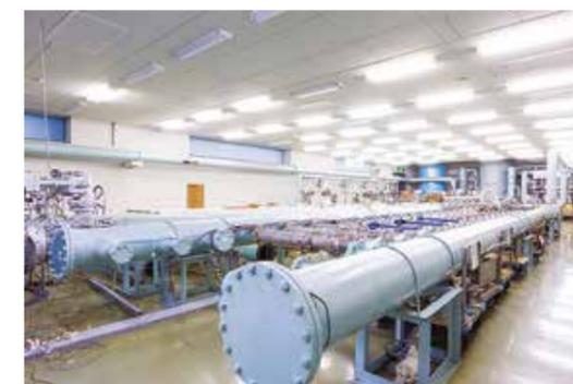
校正サービスセンター内には、閉ループ式流量計校正システムが設置されている。このシステムに臨界（音速）ノズルが挿入されている。
